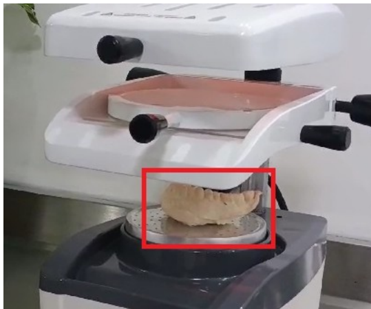
Ábra. Példa egy nem lecsiszolt modellre, amely megakadályozza a megfelelő légáramlást.
